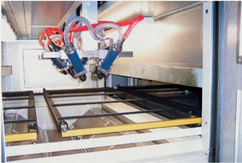
▲ Aus acht Düsen wird der CO 2 -Schnee auf die Werkstücke gestrahlt
