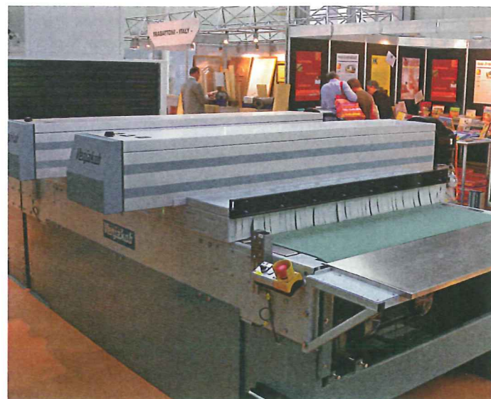
Verbesserte Technik beim Ven Dry UV: Aushärten im Durchlauf
