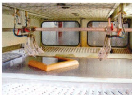
Der Flächenspritzautomat kann auch Rahmen und flache Gestelle lackieren
